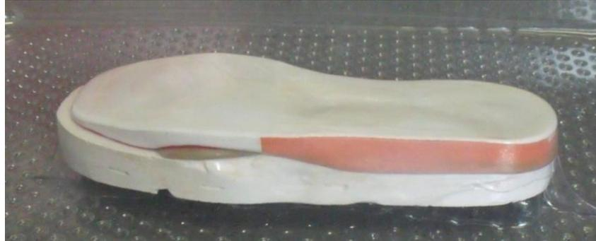
**Thermoformage d'un plastique sur l'ensemble**
