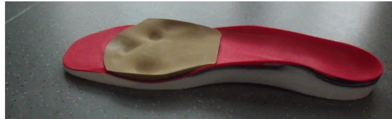
Thermoformage de la semelle au dessus du gabarit
