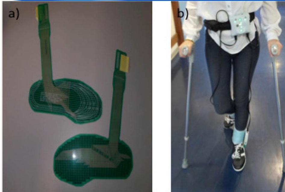
**Fig. 1** Dispositif matériel du système F-Scan® : semelles embarquées comportant des capteurs résistifs, boîtiers d'interface fixés aux chevilles, boîtier d'acquisition relié à la ceinture. A) semelles à multi-capteurs ; b) boîtier d'acquisition à la ceinture relié aux boîtiers d'interface à la cheville
